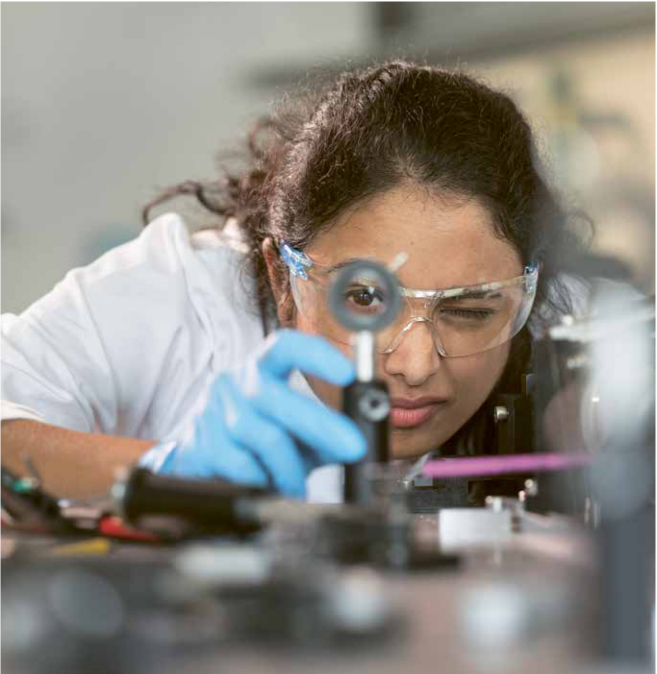
📍 Dr. Maya Giridhar justiert die Optik eines photolithographischen Synthesizers Dr. Maya Giridhar adjusting optics of a photolithographic synthesizer
